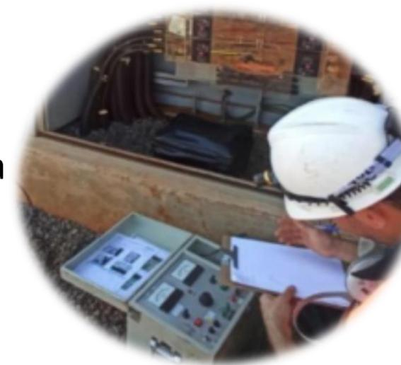
Ensaio elétrico em equipamentos, TR's, Disjuntores.
